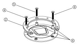
3. 将零件①放置在零件②上方(注意将孔位对齐),放入螺丝,并依次紧固螺丝。(扭力: 1.5N·m)
